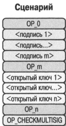
Рис. 8.4. Начальное состояние простой мультиподписи
