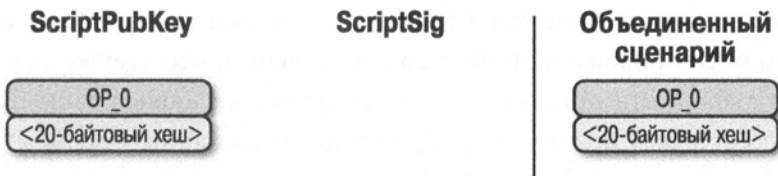
Рис. 13.3. Поля ScriptPubKey и ScriptSig для оплаты по хешу открытого ключа с отдельным заверением (p2wprkh)
