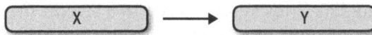
Рис. 6.4. Операция OP_HASH160 выполняет сначала хеш-функцию sha256, а затем — хеш-функцию ripemd160 над элементом на вершине стека
